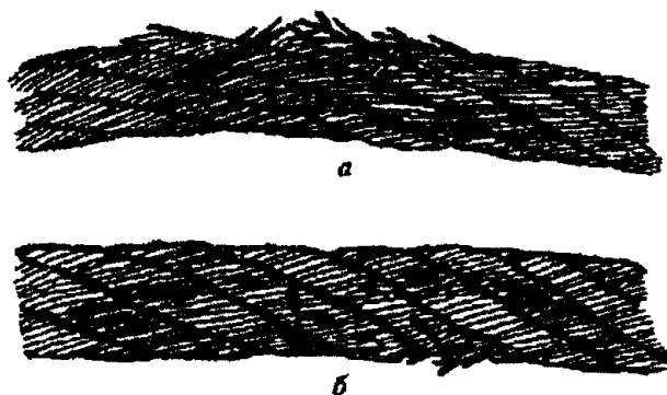
Рисунок 3. Обрывы проволок в зоне уравнительного блока:
